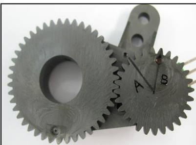
Fig.30 Alignment of gear system "A" Alineación "A" marca engranaje
