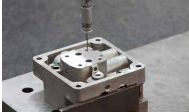
Mediciones 3D en CNC / 3D measurements in CNC / Mesures 3D CNC.
